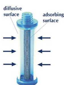
Figure 3 : Echantillonneur passif RADIELLO® avec sa membrane blanche sur support prêt à être exposé.
