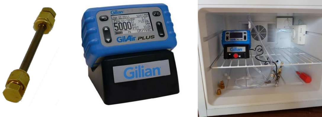
Figure 2 : Matériel de prélèvement utilisé pour la mesure du 1,3-butadiène et du benzène avec de gauche à droite un tube actif, une pompe et une enceinte de mesure à température régulée installée dans un bâtiment.
