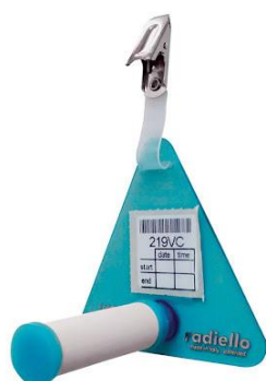
Figure 3 : Echantillonneur passif RADIELLO® avec sa membrane blanche sur support prêt à être exposé.
