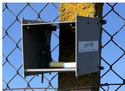
Figure 3 : Echantillonneur passif RADIELLO® avec sa membrane blanche sur support prêt à être exposé.
